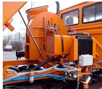
Gasdichter Radialventilator in zweistufiger Ausführung für den Transport von Wasserstoff.
