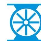
Der Einsatz von Zellenradschleusen dient zum kontrollierten Austragen und Dosieren von körnigen und pulverigen Materialien wie Stäube, Späne und faserige Schüttgüter sowie als Absperrorgan. Je nach Baugröße und Ausführung bieten unsere Zellenradschleusen ein Durchsatzvolumen von 7,5 bis 9.122 m<sup>3</sup> und somit eine hohe Einsatzvielfalt.
